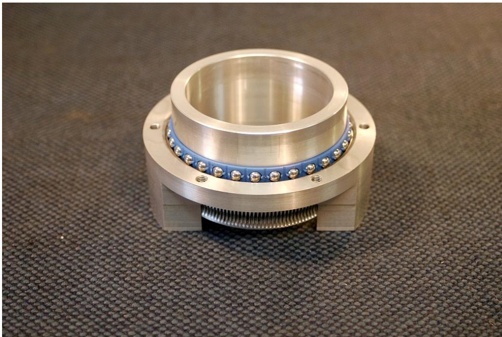
Abbildung 6: Lagerring unten und Vixen Schneckenrad mit Lagerelement LEL
